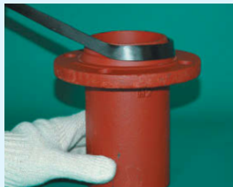
ガスケット取付
