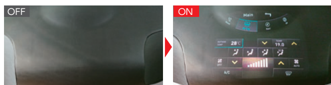
「皮革調立体タッチパネル」デモ機 OFF状態では皮革調だが、ON状態ではタッチパネルに変化
