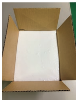
端材緩衝材の使用例
