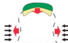
③ウレタンの発泡圧で、トンネルが有する本来の機能を回復させる。
