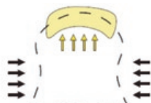
①変状トンネルの天端背面の空洞を充填する。
