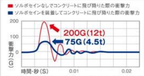
データは、体重60kgの人が厚さ7mmのソルボセインをかかと部に付けて、30cmの高さから飛び降りたときの衝撃を計測したものです。
