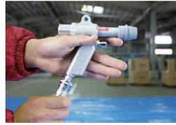
呼吸器用ポンベからエアテントに充気を行います。14.7MPa / 29.6MPa ポンベ双方に対応。最大送気圧20kPa。アスピレーター機構付き。
