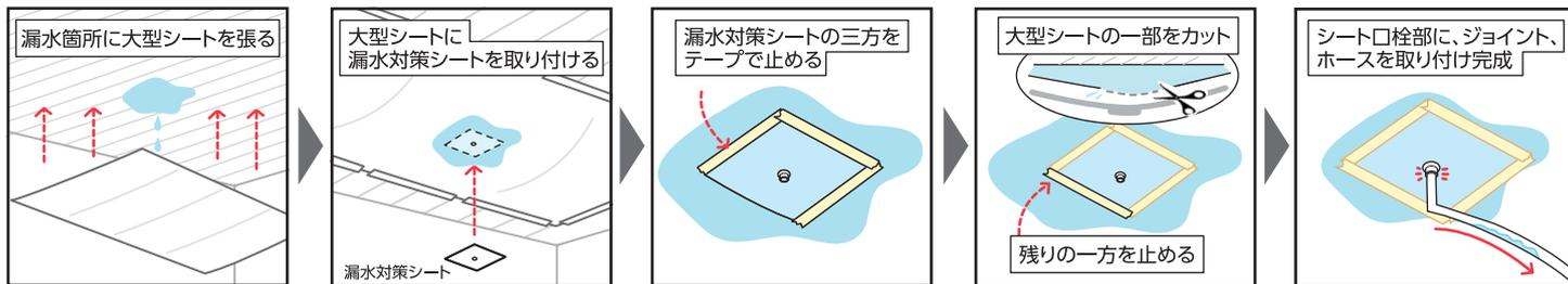
漏水箇所が小さいスペースの場合には、漏水対策シートのみでの使用も可能です。
